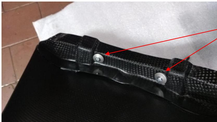
Premontare Le viti sul parafrango con le relative rondelle in dotazione (posizionando il lato gommato sul carbonio)
